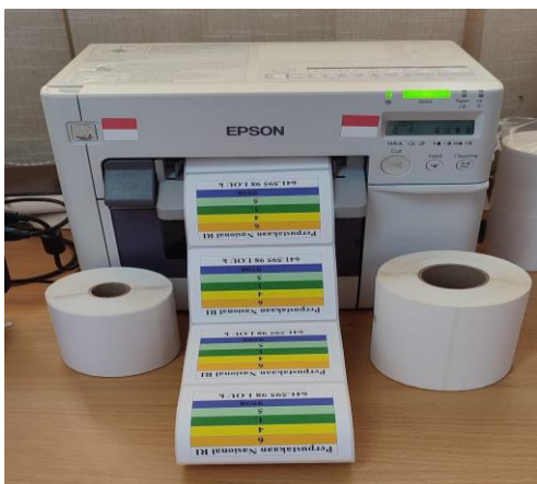
Gambar 4. Mesin Pencetak Label, Gulungan Label Besar, dan Gulungan Label Kecil
